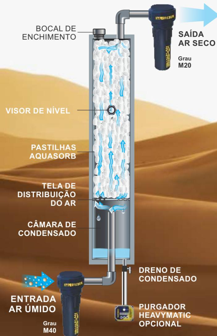
As pastilhas AquaSorb absorvem a umidade do ar comprimido formando um líquido que será drenado na parte inferior do secador.
