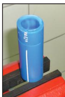
08) Estado do corpo de prova no final do teste de Ductibilidade.
