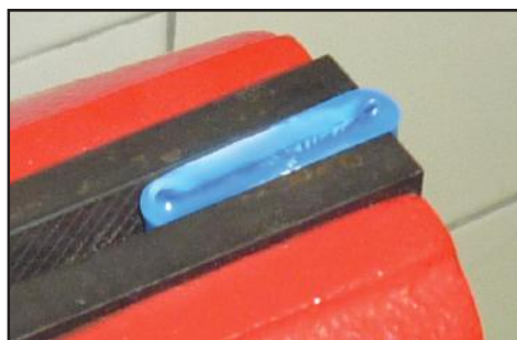
05) Corpo de prova com pressão máxima, sem apresentar nenhuma ruptura ou fissuras (trincas);
